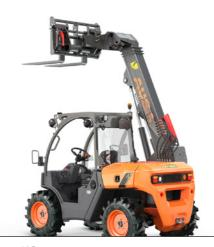
T164H 1600 KG MAXIMUM LIFT 4,000MM POWER 18.5KW WIDTH 1,480MM TRANSMISSION HYDROSTATIC
