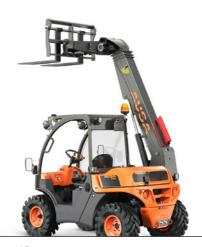
T144H 1350 KG MAXIMUM LIFT 4,000MM POWER 18.5KW WIDTH 1,405MM TRANSMISSION HYDROSTATIC
